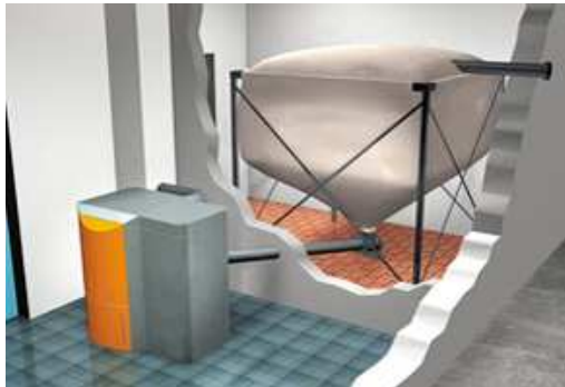
Schéma de principe d'une chaudière à granulés (source Ökofen)
