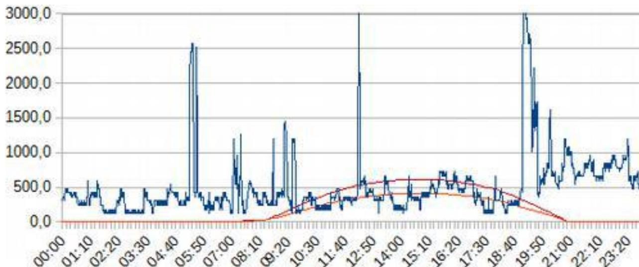
Si la **production** dépasse la **consommation**, quelques wattheures produits en surplus ne seront pas consommés et seront « donnés » au réseau. Mais cela n'arrivera que dans les cas d'ensoleillement optimal. Il reste plus intéressant d'être légèrement au-dessus de vos besoins que de produire deux fois moins avec un seul module.
