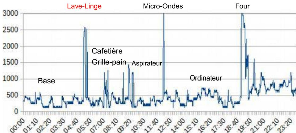
On constate une partie variable avec des pointes pouvant dépasser plusieurs kilowatts correspondant à l'usage de divers appareils et une « base », habituellement entre 200 et 400 watts selon les maisons, quasi constante, liée à des appareils toujours actifs, même si vous êtes en absents ou en vacances, (réfrigérateur, congélateur, VMC, box internet, appareils en charge ou en veille, réveils...). Cette partie stable de vos consommations est aussi appelée « bruit de fond ».
