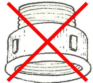
Ne pas utiliser à la fois dans un circuit du cuivre et de l'acier galvanisé : électrolyse et dégradation du circuit par corrosion assurées !!!
